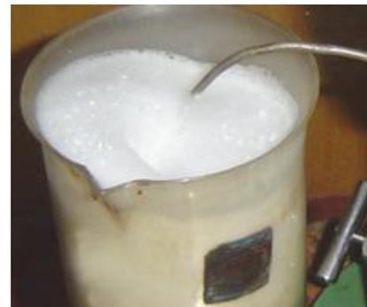
特点：（1）泡沫对地层渗透率有选择性，堵大不堵小，即泡沫对高渗层具有较强的封堵作用，而对低渗层的封堵作用较弱。
