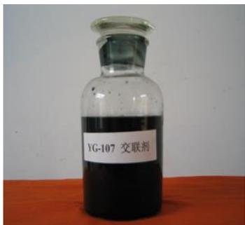
一种有机铬交联剂SD-107冻胶。特点：成冻强度高，时间和强度可控，用于70度以下常温地层。
